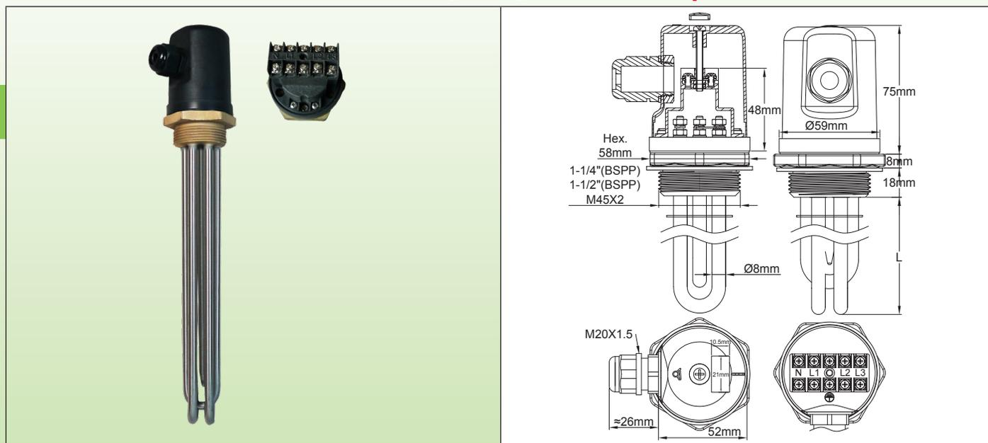
**Principales aplicaciones:** calentamiento de líquidos, circuitos de agua caliente, contenedores y tanques de almacenamiento. Estos calentadores en inmersión son los más pequeños con caja de distribución y 3 componentes de calefacción. Han sido diseñados con un bloque de conexión incorporado para facilitar el cableado. Su tamaño reducido no permite tener un termostato en su interior.
