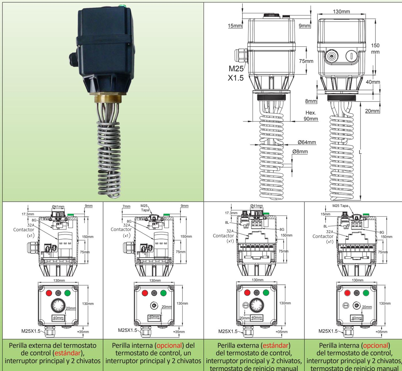
**Principales aplicaciones:** Calefacción líquida industrial, circuitos de agua caliente, contenedores y tanques acumuladores, **en aplicaciones donde la longitud sumergida de los componentes de calefacción debe ser lo más corta posible.** Pueden equiparse con uno o dos. Tienen de serie un relé de 32 A res, tripolar, dos chivatos y un interruptor principal. Están destinados para uso en interiores.
