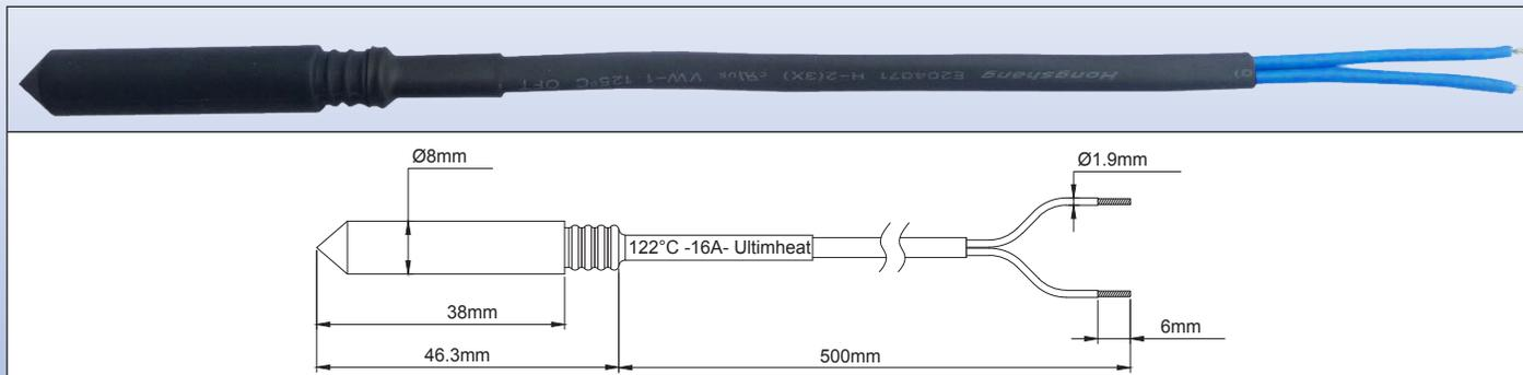
**Aplicaciones:** protección contra el sobrecalentamiento de equipos y componentes de calefacción.
