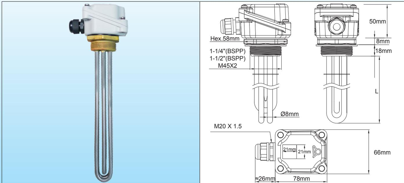
**Principales aplicaciones:** calentamiento de líquidos, circuitos de agua caliente, contenedores y tanques de almacenamiento. **Estos calentadores en inmersión son los más pequeños con 3 componentes de calefacción y carcasa de aluminio. No hay suficiente espacio en el interior para el termostato. No tienen un bloque de conexión incorporado.**
